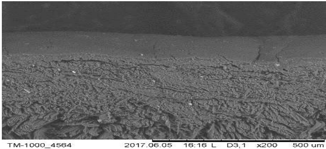
Şekil 2: 80°C'de kurutma sonrası derinin kenar boyasında oluşan çatlaklar
