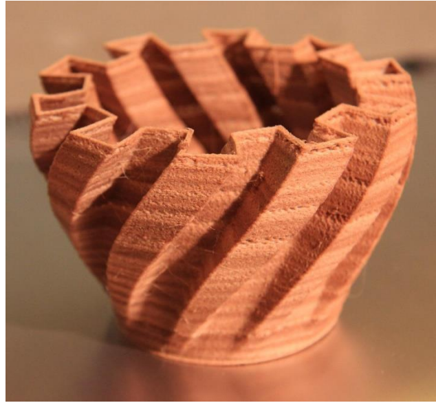
Resim 3. Laywoo-3D filamentle üretilen vazo
